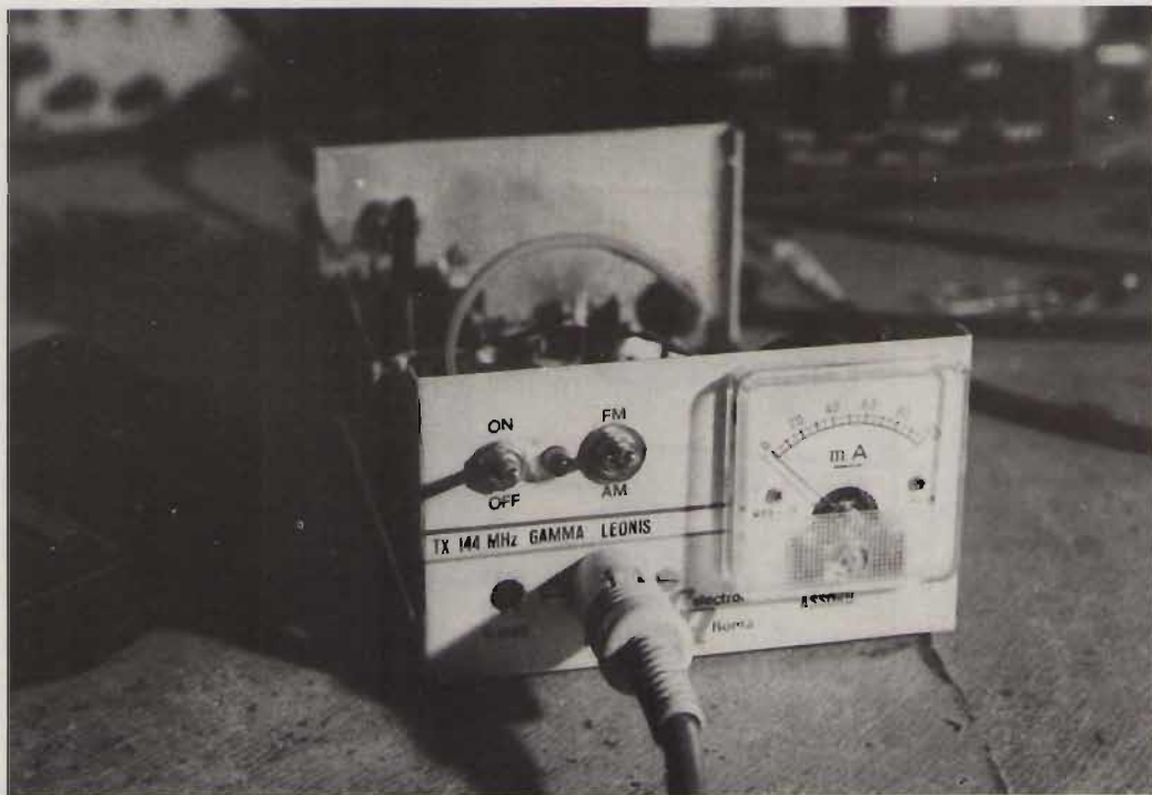
Foto di un prototipo: il trasmettitore "Gamma Leonis", a montaggio quasi ultimato, durante le prove.
